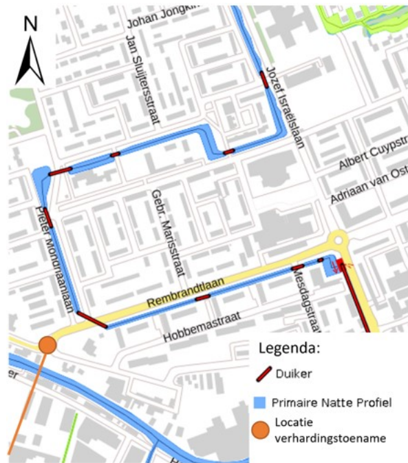
Afbeelding 4.6 Mogelijkheid voor inpassing van watercompensatie buiten het plangebied: uitbreiding van bestaande watergangen
