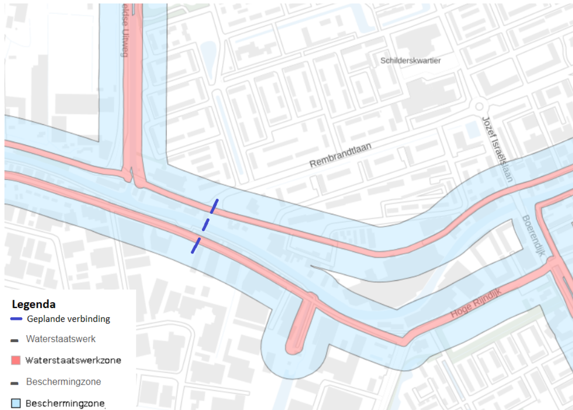
Afbeelding 3.13 Overzicht van waterstaatswerken en beschermingszones in de omgeving van de geplande brugverbinding
