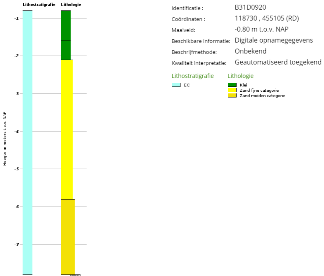
Afbeelding II.3 Boormonsterprofiel B31D0920 genomen aan de Hollandbaan/Gildenweg
