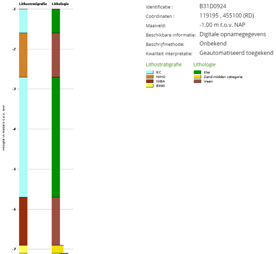
Afbeelding II.1 Boormonsterprofiel B31D0924 genomen aan de Touwslagerweg
