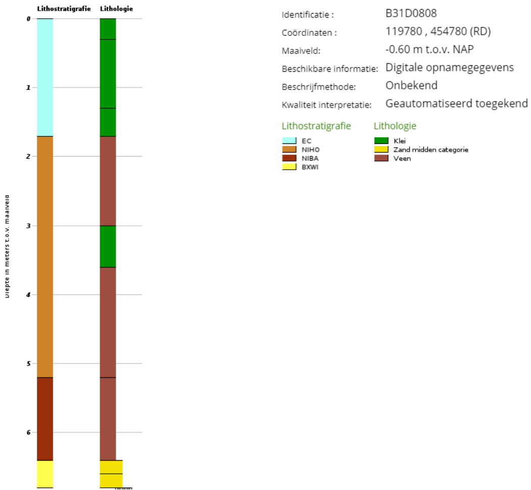
Afbeelding II.5 Boormonsterprofiel B31D0808 genomen aan de Lindenlaan
